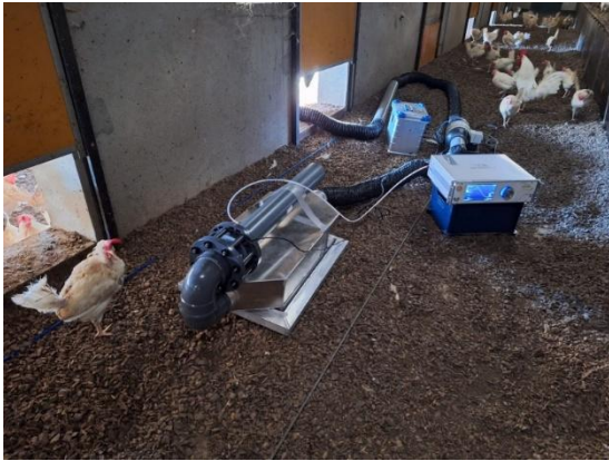
Figuur 1: De dynamische boxmethode toegepast tijdens metingen op de substraatlaag in de scharrelruimte mét mestschuifel in Lunteren.
